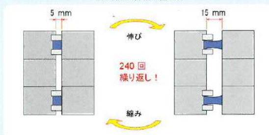
軸方向 変位量 10mm (240回の繰返し変位)
