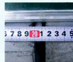
継手間隔 15mm (軸方向変位量10mm)
